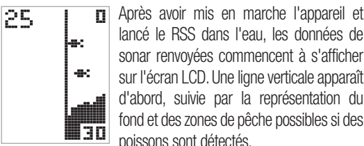
Les changements d'échelle de profondeur ou la perte de signal engendrent des lignes avec des détails manquants et/ou des changements brutaux du fond dans la représentation graphique.
